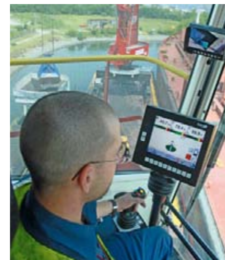
Zusätzliche Arbeitsschritte für den Wiegevorgang, wie z.B. mit Hoppnern, entfallen mit der Gottwald Lastwaage
